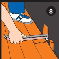
Winkeln Sie nun die Elemente der letzten Reihe wie gehabt ein. Mit Hilfe eines Zugeisens können Sie eventuell noch vorhandene kleine Fugen mit leichten Schlägen schließen. Auch hier müssen Abstandskeile eingesetzt werden.
